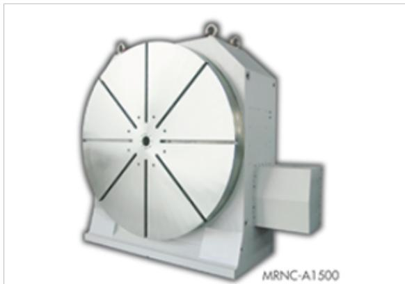
潭兴四轴转台工作技术特点（九）潭兴第四轴分度盘方法和功能可分为①分度盘：用途\*为普遍。主轴可在水平和垂直方向间倾斜任意角度。分度机构由分度盘和传动比为1: 40的蜗杆-蜗轮副组成，分度盘上有多圈不同等分的定位孔。转动与蜗杆相连的手柄将定位销插入选定的定位孔内，即可实现分度。当分度盘上的等分孔数不能满足分度要求时，可通过蜗轮与主轴之间的交换齿轮改变传动比，扩大分度范围。在铣床上可将分度盘的交换齿轮与铣床工作台的进给丝杠相联接，使工件的轴向进给与回转运动相组合，按一定导程铣削出螺旋沟槽；②半分度盘：结构与分度头基本相同，但不带交换齿轮机构，只能用分度盘直接分度，不能与铣床工作台联动。③等分分度盘：一般采用具有24个槽或孔的等分盘，直接实现2、3、4、6、8、12、24等分的分度，有卧式、立式和立卧式3种。立卧式的底座带有两个互相垂直的安装面，主轴可以处于水平或垂直位置。通用分度盘的分度精度一般为±60”。石家庄通用电脑数控分度盘厂家直销杭州千岛拓新，打造专业品牌，高质量的象征！
