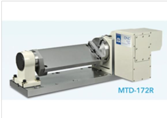
潭兴转台——双导程蜗轮蜗杆潭兴蜗轮蜗杆间隙调整（二）潭兴蜗杆的材质是镍铬钼合金钢，渗碳热处理硬度达HRC60°，渗碳深度0.3mm~0.4mm。因此蜗杆本身有相当高之刚性与耐磨性。蜗轮的材质采用铝青铜，其材质特性经长久耐磨可消除震动，本公司所使用的铝青铜为3号ALBC3，比一般制造厂采用磷青铜或ALBC1（1号），其抗拉强度高出一倍，且与蜗杆接触之备滑性较高。（◎将分度盘载重，每小时旋转一圈来测试，观察电流负荷变化就可得知其平滑性。某使用单导程蜗杆厂家经测试，电流变化不稳定，其蜗杆及蜗轮接触之平滑性更不理想。）
