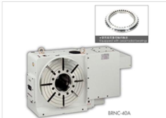
电脑数控分度盘的正常使用和维护注意事项（三）分度盘是各类铣床的主要附件是不可缺少的工具，它能将装在顶针之间或卡盘上的工件分成任意角度或等分，可进行沟槽、正齿轮等工序。分度盘是简单型的分度中心且能被用于直、接间的分度法，对于特写的分度及螺旋式的加工在内，不需配件，但整个分度盘结构和尾座与那些万力型是一致相同。5、分度盘上装夹工件时，一般需要锁紧分度头主轴，但在每次分度前，都要把刹紧分度头主轴的手柄松开，分度完成后再把它锁定，以防止分度头主轴在铣削过程中松动；6、分度时，摇柄上的定位插销应对正孔眼，慢慢地插入孔中，不能突然撒手让插销自动弹入孔中，否则，久而久之，孔眼周围会产生磨损，加大分度中的误差；7、分度中，当摇柄转过预定孔的位置时，必须把摇柄向回多摇些，消除了蜗轮和蜗杆间的配合间隙后，再使插销准确地落入预定孔中；8、分度头的主轴不但可以与工作台平行，还可以使主轴与工作台垂直或成某一角度。当分度头回转体需要扳转角度时，要先松开壳体上的紧固螺钉，严禁任何对壳体的敲击。东奔西走找电脑数控分度盘，选择千岛拓新，为您解决后顾之忧！石家庄通用电脑数控分度盘厂家直销
